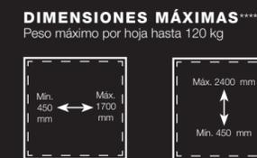
\*\*\*\*Las medidas máximas mostradas son orientativas ya que éstas varían en función del tipo de perfil, del tipo de apertura, del refuerzo, del color de la perfilera, etc. Para más detalle solicite los abacos al Dpto. de Prescripción.
