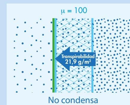
DANOPREN XPS tiene un valor  $\mu$  suficientemente adecuado para no provocar condensaciones intersticiales.
