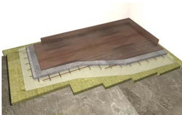
En cuanto a requerimientos térmicos, ISOVER recomienda que para particiones horizontales en contacto con los cimientos del edificio sea  $R_{\geq} 1,4 \text{ m}^2 \text{ K/W}$ , mientras que para techos o suelos a partir de la primera planta  $2 < R < 3 \text{ m}^2 \text{ K/W}$ .
