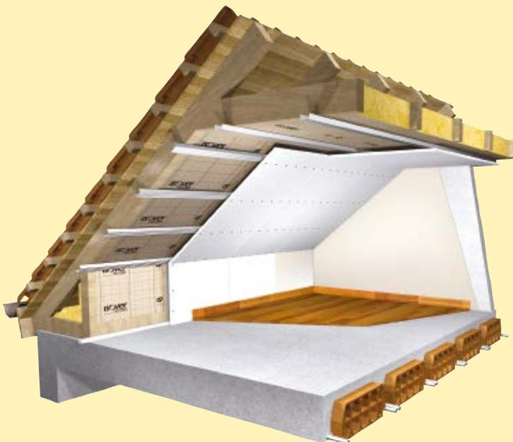
Para asegurar el buen aislamiento térmico, la resistencia térmica de la cubierta R, debe ser lo mayor posible, nos indica la capacidad de un material para evitar las transferencias de calor que lo atraviesan. Este concepto también es aplicable a la cubierta en su conjunto. Este parámetro es el resultado del cociente entre el espesor, e (m) y la conductividad, λ (W/m·K).
